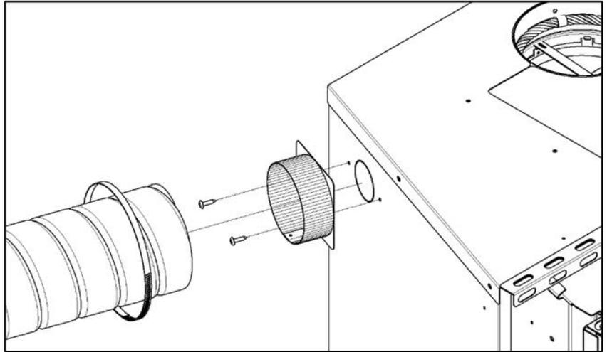
Figure 4-6: Installation de l'ensemble d'air frais
