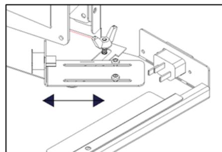
Illustration 4-4: Ajustement d'interrupteur thermique (thermodisque)
